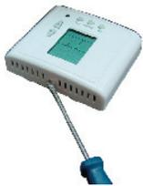
1) Presionar la lengüeta ubicada en la parte superior de la unidad para separar el panel frontal de la base
