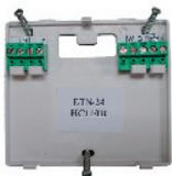
3) Nivelar la base, ya sea contra la pared o una superficie plana, sobre la cual será montado, y coloque los tres tornillos en los agujeros correspondientes.
